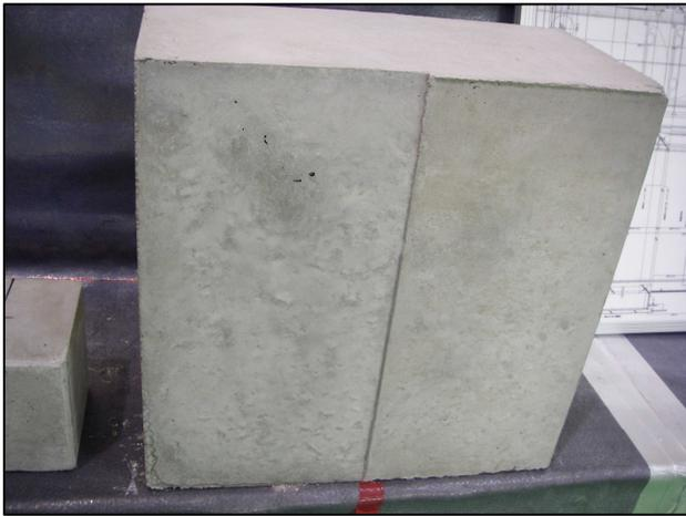
写真-5 RC 供試体 (段差 1 mm : 表)
