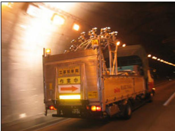
写真-1 ひび割れ検出システム<sup>3)</sup>
