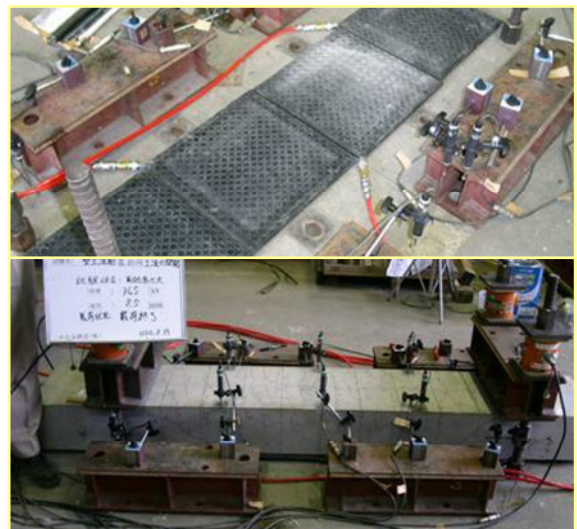
写真-1 荷重試験状況 (上はゴムバッグ)
