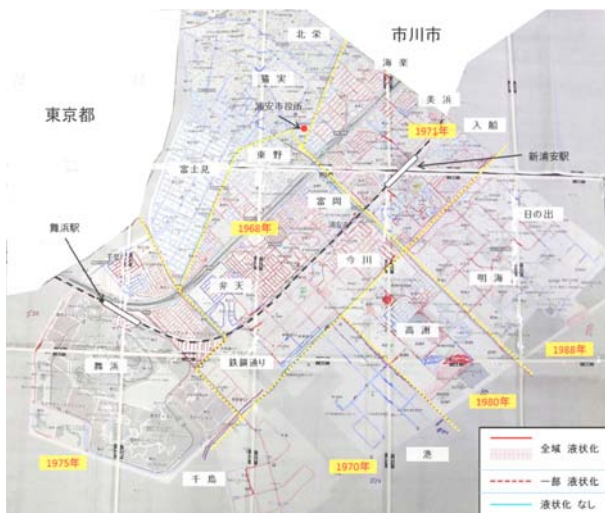
図-12 東畑研究室による新浦安地域の液状化調査
