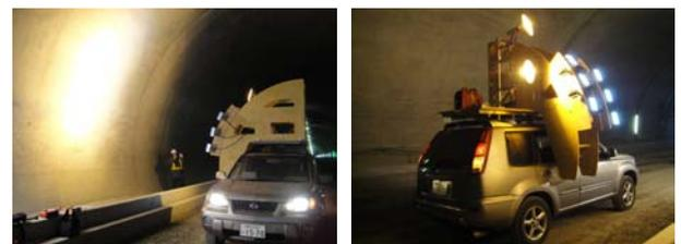
写真-1 トンネル画像計測車両（試作版）
