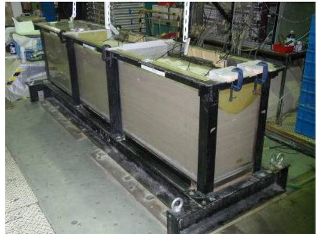
写真-2 振動台と2次元固定土層
