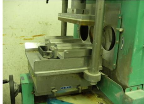
写真-1 コンクリート用端面研磨機
