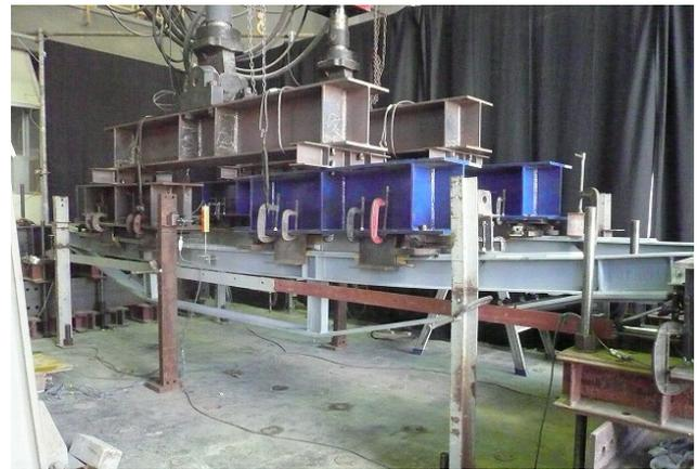
写真-2 ESB2の最大荷重時の変形状態
