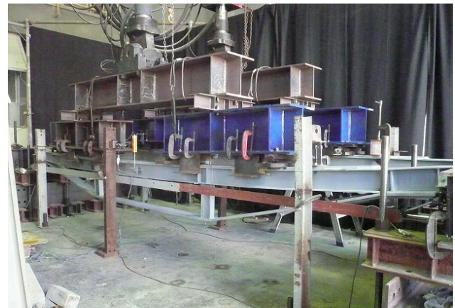
写真-2 ESB2の最大荷重時の変形状態
