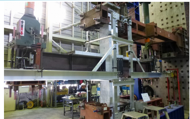
写真-1 十字形架構試験体(F60)の加力状況
