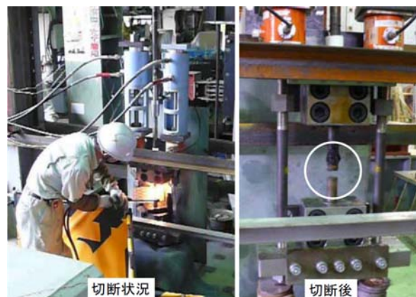
写真-7 くさび定着による応力開放装置 7)
