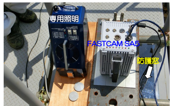
写真-3 観察ステージ上での高速度カメラの設置
