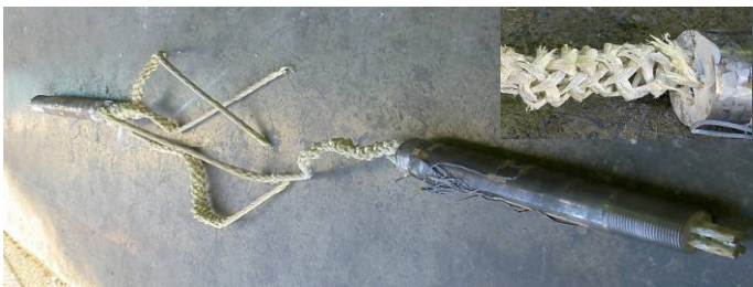
写真-2 アラミドロッド破断状況
