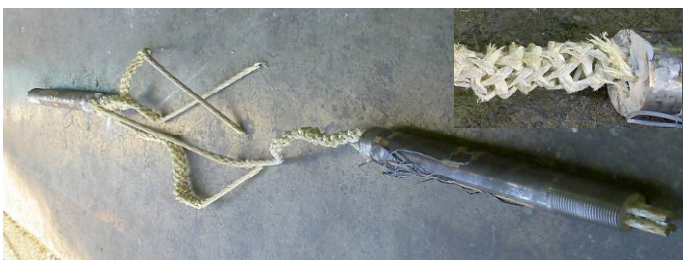
写真-2 アラミドロッド破断状況
