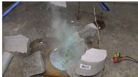
写真-4 放電破砕による円柱供試体破壊
