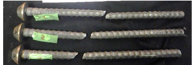
写真-2 勾配引張試験 破断状況
