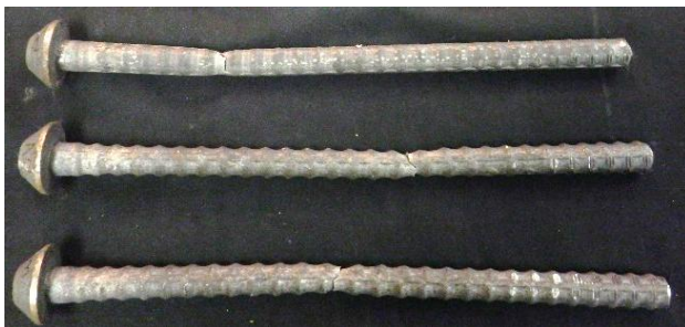
写真-3 高応力繰り返し試験 破断状況
