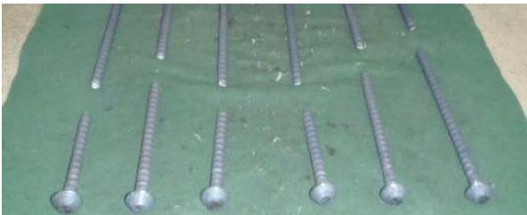
写真-1 引張試験の破断状況
