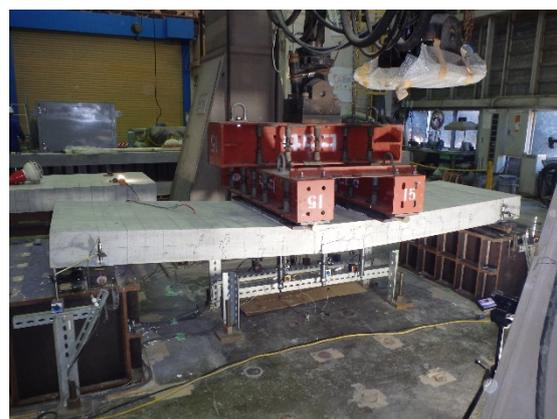
写真-2 継手部を有する試験体の静的曲げ載荷実験
