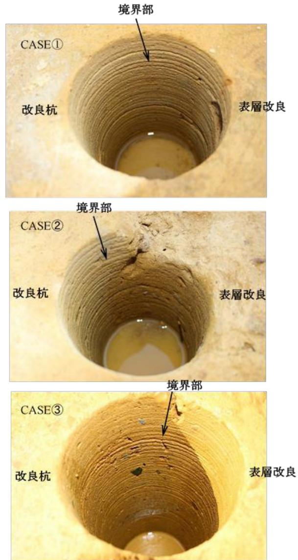
図-21 表層改良 / 改良杭境界部サンプリング孔
