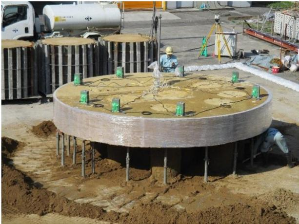
図-14 試験体取出し状況
