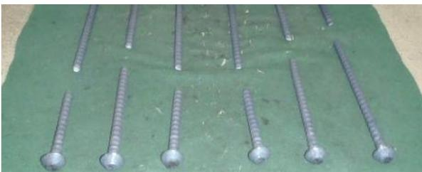
写真-1 引張試験の破断状況
