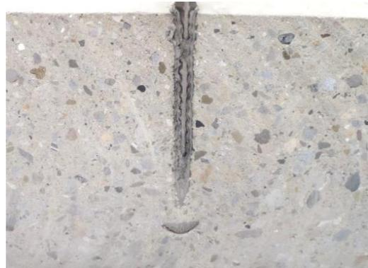
写真-4 引抜き試験 突起部状況
