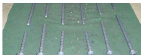
写真-1 引張試験の破断状況
