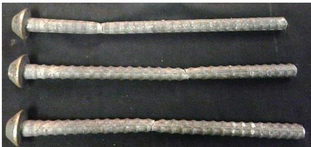
写真-3 高応力繰り返し試験 破断状況
