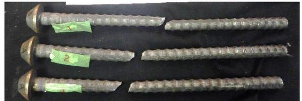
写真-2 勾配引張試験 破断状況
