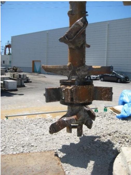
図-9 攪拌ヘッド(φ600mm)
