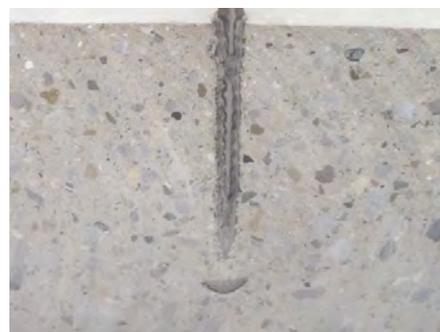
写真-2 引抜き試験後の突起部状況
