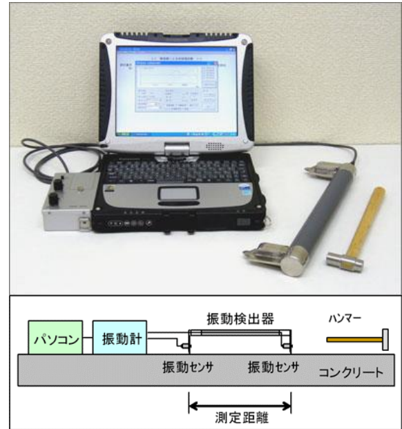
図-1 装置の概要（衝撃弾性波）
