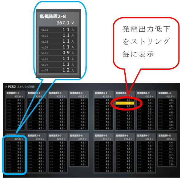
図-6 string単位の計測監視モニター
