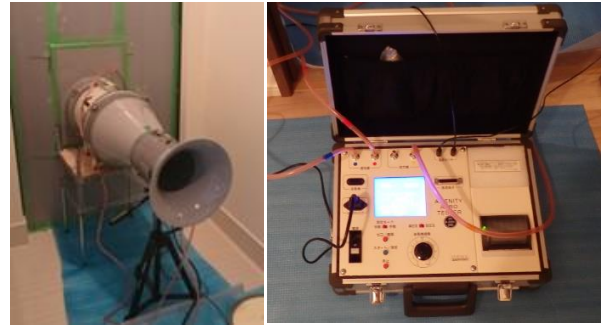
写真-1 気密測定装置
