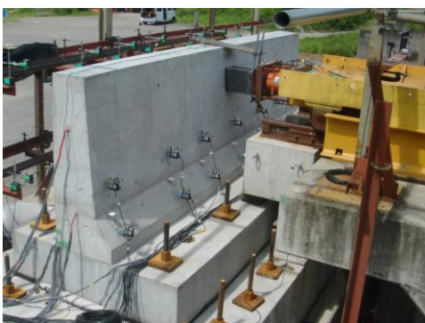
写真-5 台車による衝突試験
