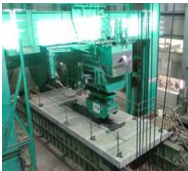
写真-1 輪荷重走行試験状況
