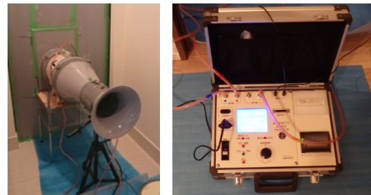
写真-1 気密測定装置
