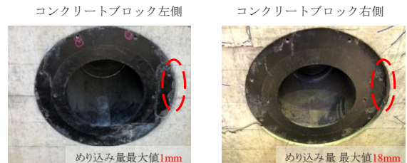
図-8 試験体破壊状況
