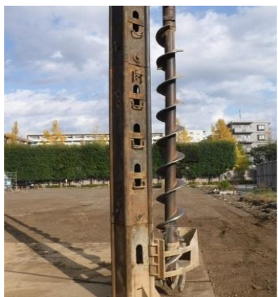
写真-3 スパイラルオーガー
