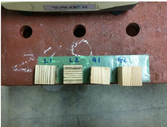
写真-3 含水率測定試験体
