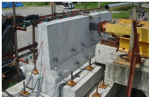
衝突試験状況 (NEXCO 試験法 441)
