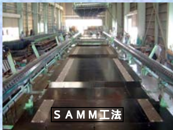
PC床版製作(プレファブ鉄筋)
