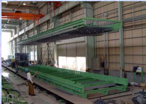
PC床版製作(プレファブ鉄筋)
