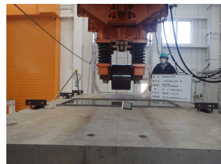
250kN, 10 万回載荷後の水張試験状況 (漏水なし)
