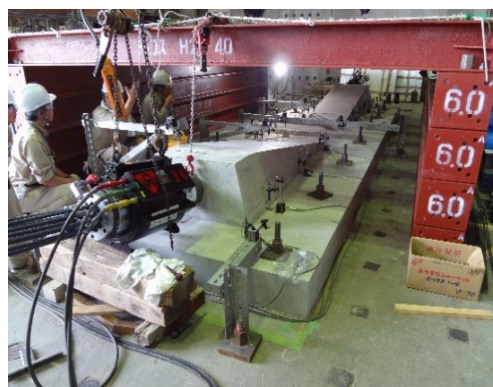
実物大載荷試験状況
