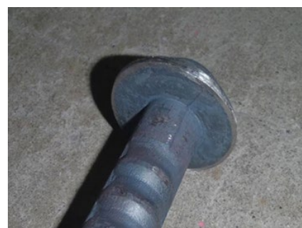
円錐台形状に拡張加工した定着体「Trunc-head」
