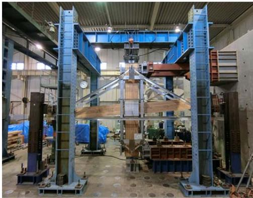
【柱梁接合部の構造実験】
