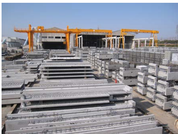
【製造後、工場内で保管される PCa 部材】
