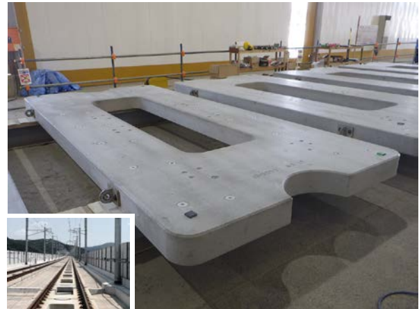
【鉄道構造物の軌道スラブ】
