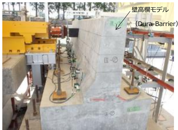
写真-3 衝突試験状況
