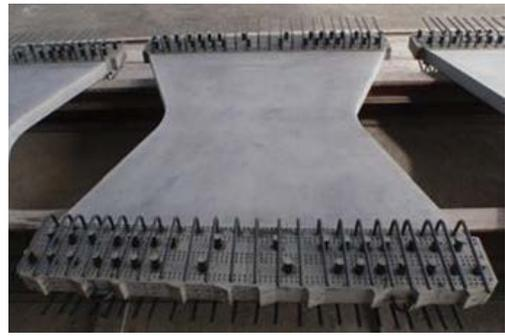
図-2 バタフライウェブ(桁側面のプレキャストパネル)
