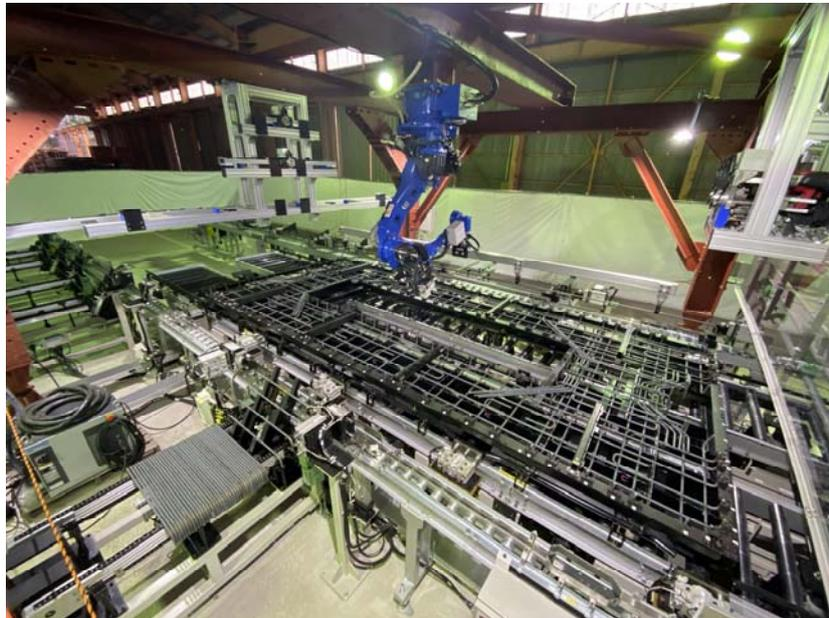
【鉄筋組立自動化システム「Robotaras™」】
