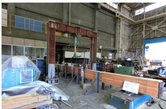
【梁の曲げ耐力試験の様子】
