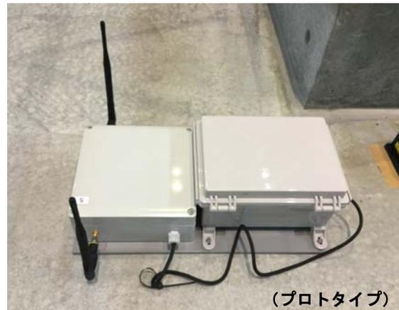
【加振実験の様子（左）とワイヤレス振動センサノード（右）】
