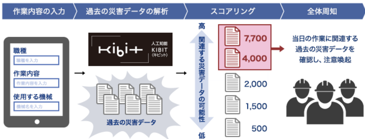
【安全注意喚起 AI システムの災害事例検索の流れ】
