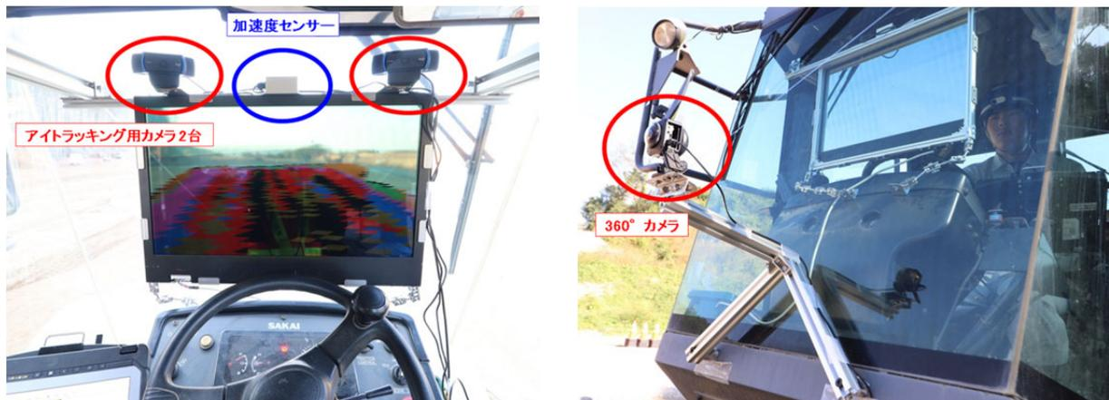
【振動ローラの設置した各種カメラとセンサー】
