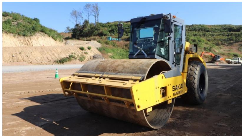
【「AR 転圧管理システム」を搭載した振動ローラ】
