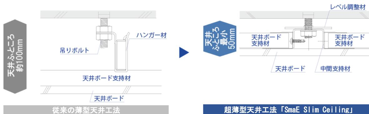
【従来薄型天井工法と比較した最小の天井懐断面】
