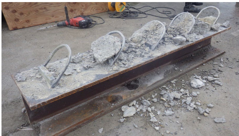
【馬蹄形ジベルのリングに沿った破碎面（模擬破碎実験）】
