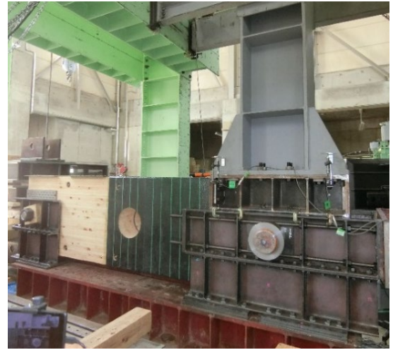
【実大実験の様子（左：ローリング・コッター耐力壁、右：木梁端部仕口の炭素繊維補強）】
