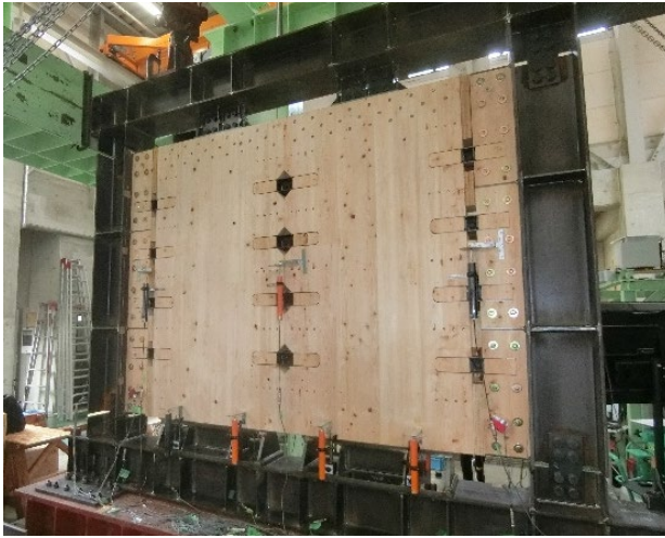
【実大実験の様子（左：ローリング・コッター耐力壁、右：木梁端部仕口の炭素繊維補強）】
