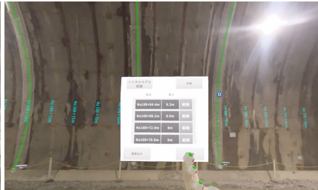
CIMモデルを重ねたXRゴーグル上の画面に計測位置と計測結果を表示
