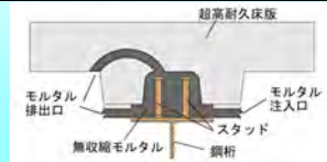
Dura-Slab の鋼桁との接合部
