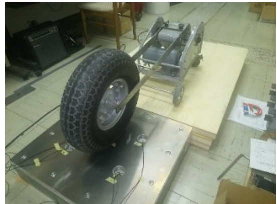
【固有振動数実験状況】
