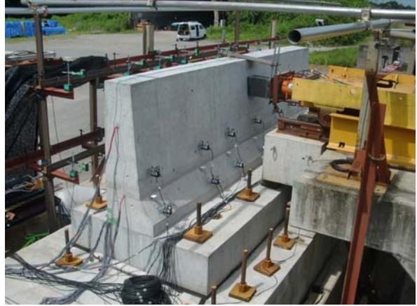
【動的載荷試験（衝突性能）】
